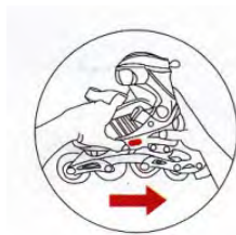
4. Натиснете пластмасовото заключващо устройство и го преместете назад, за да преустановите функцията за регулиране.
